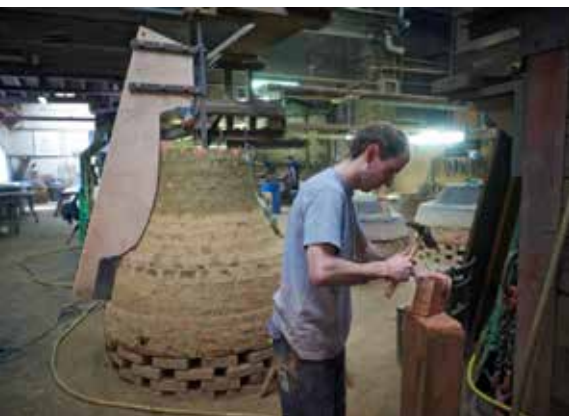
Der Kern wird gemauert.
