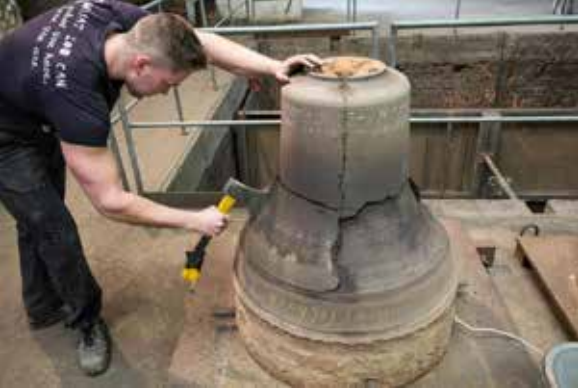
Die „Falsche Glocke“ wird abgeschlagen.
