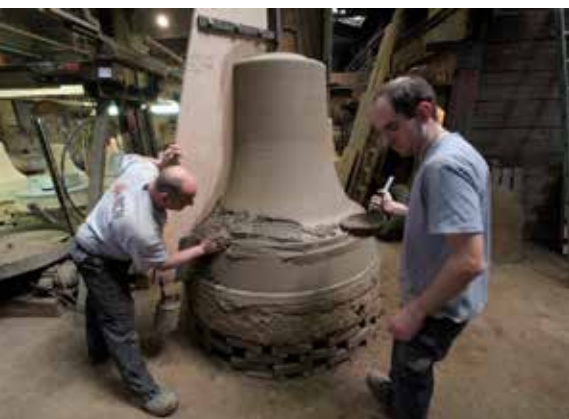
Flüssiger Lehm wird überzogen.
